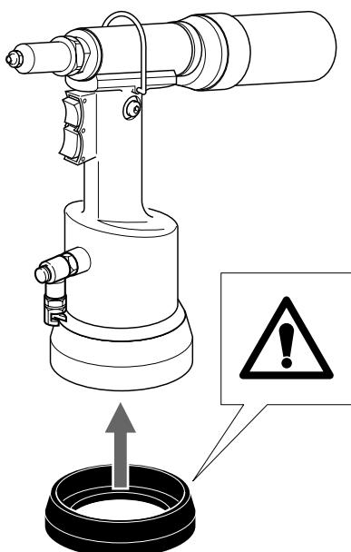
**I** **ATTENZIONE!** Prima di utilizzare la rivettatrice, montare il fondello di protezione in dotazione, come evidenziato nella figura a lato.
