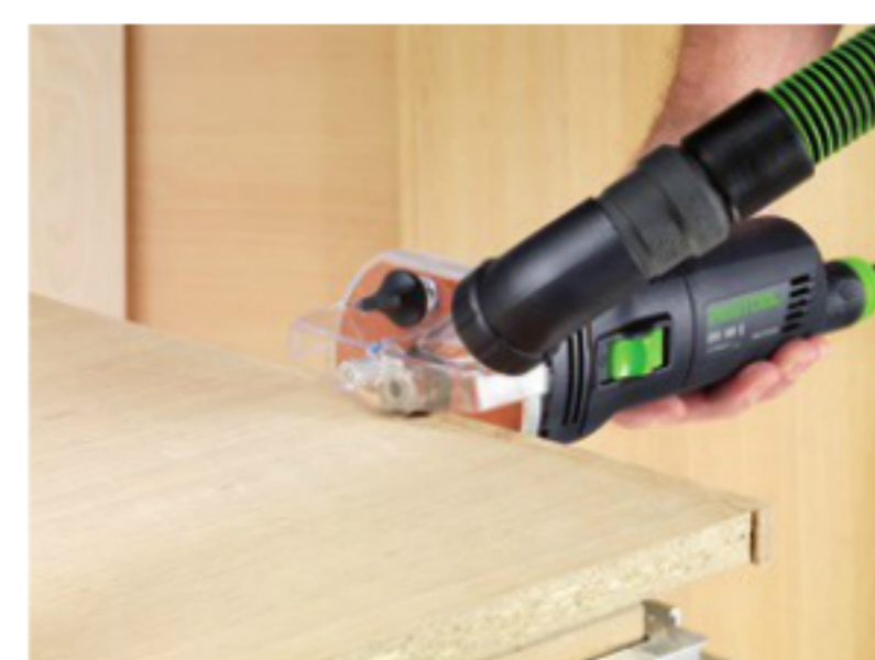
Do frezowania wyrównującego doklejek z tworzywa sztucznego lub drewna litego.
