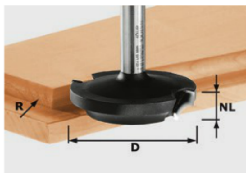
Frez do płycin, HW z łożyskiem kulkowym, trzpień 8 mm
