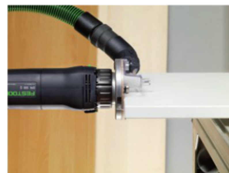
Zaokrąglanie doklejek z tworzywa sztucznego lub drewna litego.
