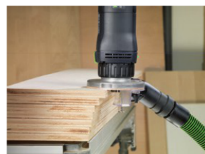
Fazowanie doklejek z tworzywa sztucznego lub drewna litego.
