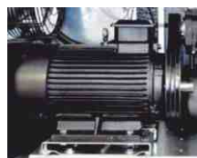
Silnik -Silnik o wysokiej sprawności IE2. Klasa F ochrona IP54
