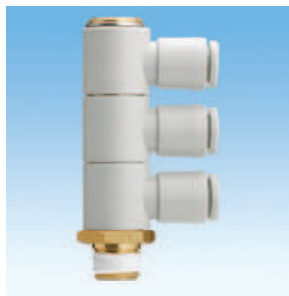
Przylączki wtykowe, kątowe, 3-krotne, nastawne w zakresie 360°, KQ2VT
