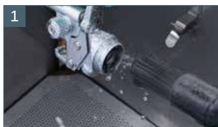
Mycie kanału materiałowego
