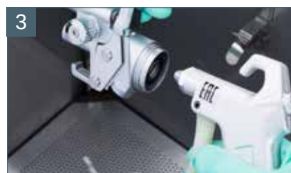
Wysuszyć za pomocą pistoletu przedmuchowego
