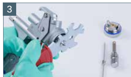
Pod koniec za pomocą uniwersalnego klucza odkręcamy dyszę materiałową.
