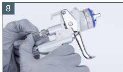
Zamontować śrubę regulatora przepływu materiału
