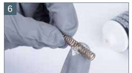
Nasmarować sprężynę i nałożyć na iglicę
