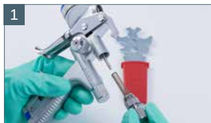
Demontując dysze, w pierwszej kolejności wyjmujemy iglicę.
