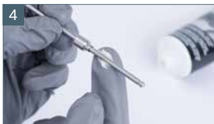
Nasmarować iglicę w obrębie uszczelki
