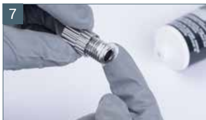
Nasmarować gwint śruby regulatora przepływu materiału
