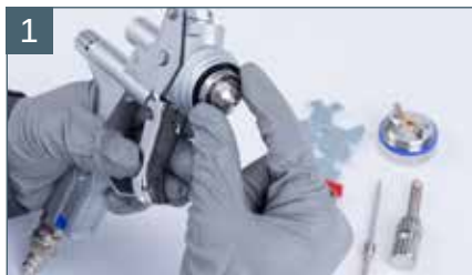
Zamontować dyszę materiałową
