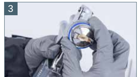
Nakręcić głowicę powietrzną
