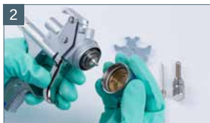
Następnie odkręcamy głowicę powietrzną.
