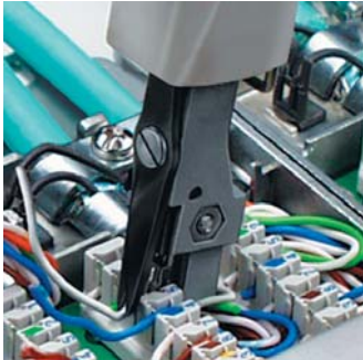
Wciskanie i odcinanie przewodu w jednej operacji
