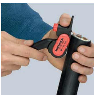
Ustawienie narzędzia do cięcia wzdłużnego
