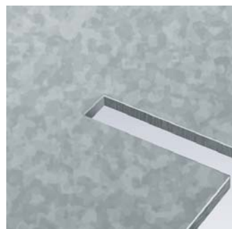
Wykrawanie i łamanie wiórów w jednej operacji
