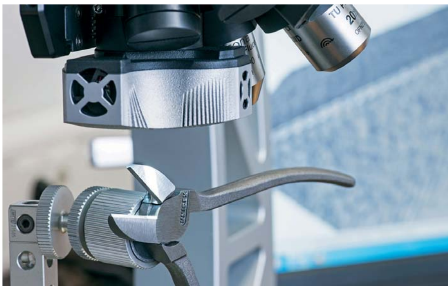
Kształt oraz chropowatość ostrzy szczypiec tnących bocznych są precyzyjnie mierzone z użyciem optycznego systemu pomiarowego 3D.
