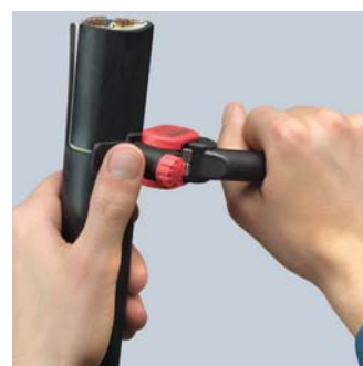
Cięcie po obwodzie
