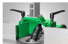
Wrzeciono frezu obrotowego do tyłu
