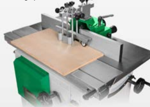
Uchwyt dolny do precyzyjnego prowadzenia obrabianego przedmiotu
