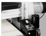
Regulacja wysokości zespołu szlifierskiego czytelna na skali
