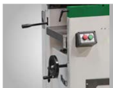
Regulacja stołu grubościówki poprzez pokrętkę ręczną
