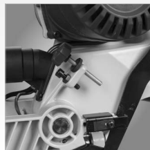
Dwustopniowy ogranicznik głębokości cięcia
