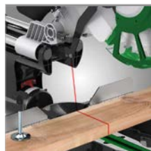
Laser wskazujący idealną linię cięcia
