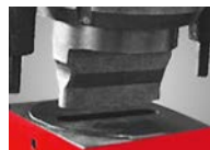
▶ Opcjonalne urządzenie wytłaczające do dużych średnic
