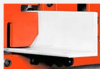
▶ Nożyce do kątowników stalowych
