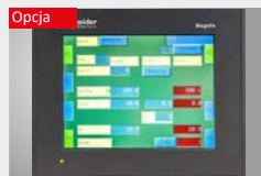
Opcjonalny sterownik Schneider CNC3A, sterownik trójosłowy do cyfrowego wprowadzania kąta, wprowadzania pozycji ogranicznika tylnego i pozycji otworu lica z możliwością zapisywania sekwencji fazowania, silnikowy ogranicznik tylny z palcami oporowymi, zakres przemieszczania 15-1000 mm
