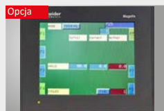
Opcjonalny sterownik Schneider TM 238, sterownik jednoosłowy do cyfrowego wprowadzania kąta na dużym ekranie dotykowym z możliwością zapisywania sekwencji fazowania
