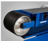
▶ Duże koło kontaktowe i napędowe (MBSM 150-200-2)
