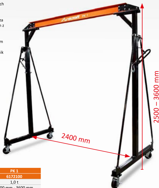
Stabilna konstrukcja wsporników
